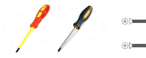
រូបទី 1.3 លក្ខណៈតួឯកវ៉ិសផ្កា ( Phillips-Head Screwdriver )
